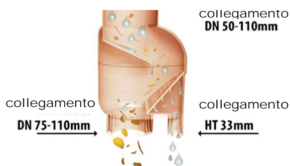
Figura 2: esempio di filtro lungo il pluviale
