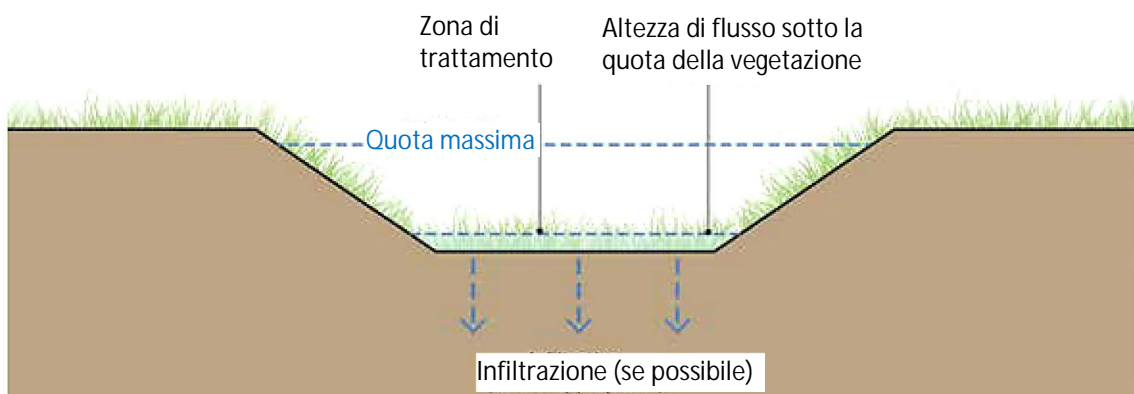
Figura 8: tipica sezione di un canale inerbito.
