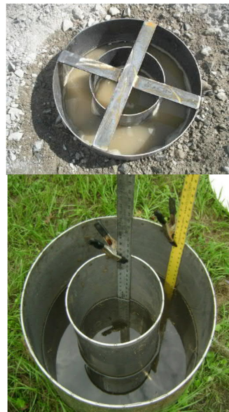
Figura 5: schema di flusso sotto l'infiltrometro e immagini di misure in corso
