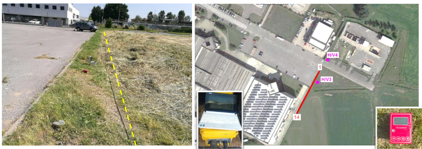
Figura 51: stesa del cavo multipolare e dei geofoni della prova MASW e Re.Mi. 2 visti da sud ovest. In basso il Sismografo "Geode" collegato al pc e a destra lo strumento di registrazione delle misure H/V (Tromino Engy ©) nella posizione 3.
