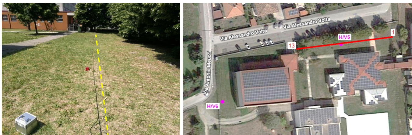
Figura 52: stesa del cavo multipolare e dei geofoni della prova MASW e Re.Mi. 3 visti da est.
