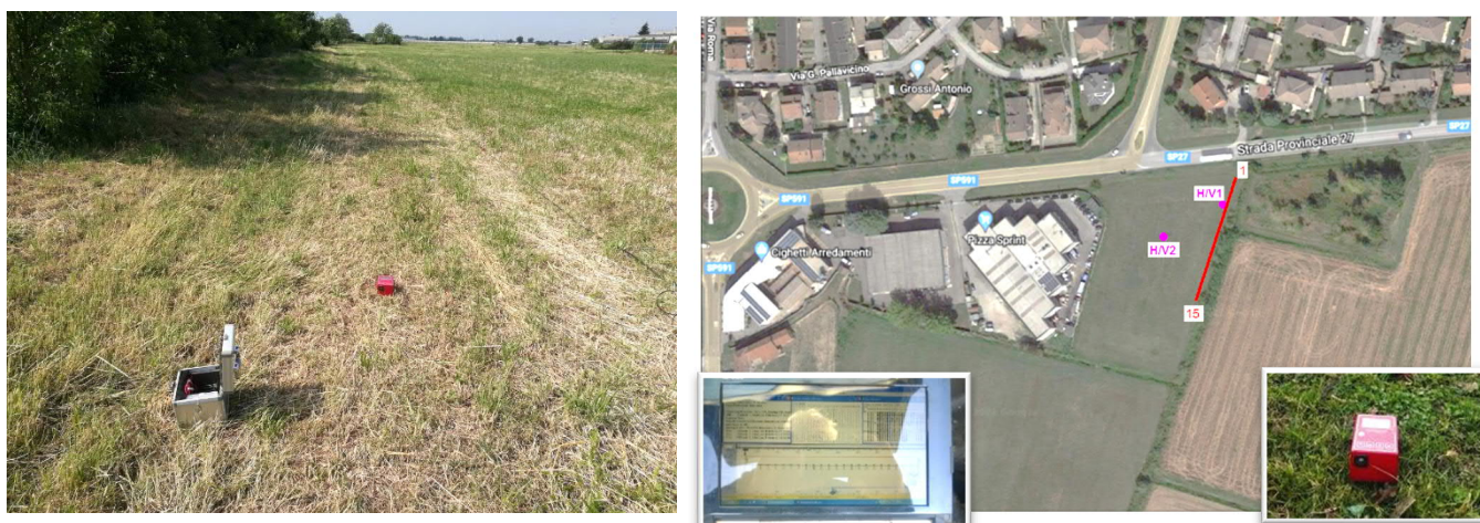
Figura 50: stesa del cavo multipolare e dei geofoni vista da nord. In basso a destra la schermata di acquisizione delle prove MASW 1 e Re.Mi. 1 e lo strumento di registrazione delle misure H/V (Tromino Engy ©).
